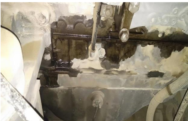
Неисправность: Двигатель Моторное масло Картерными газами выдовило масло с ДВС. Выдовило прокладку поддона ДВС.
