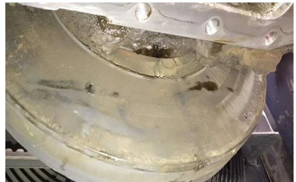
Неисправность: Двигатель Картерными газами выдовливает сальник..
