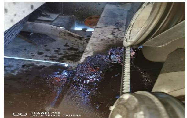
Неисправность: Двигатель Моторное масло Обильная течь с передней крышки ДВС. Выдовило передний сальник.
